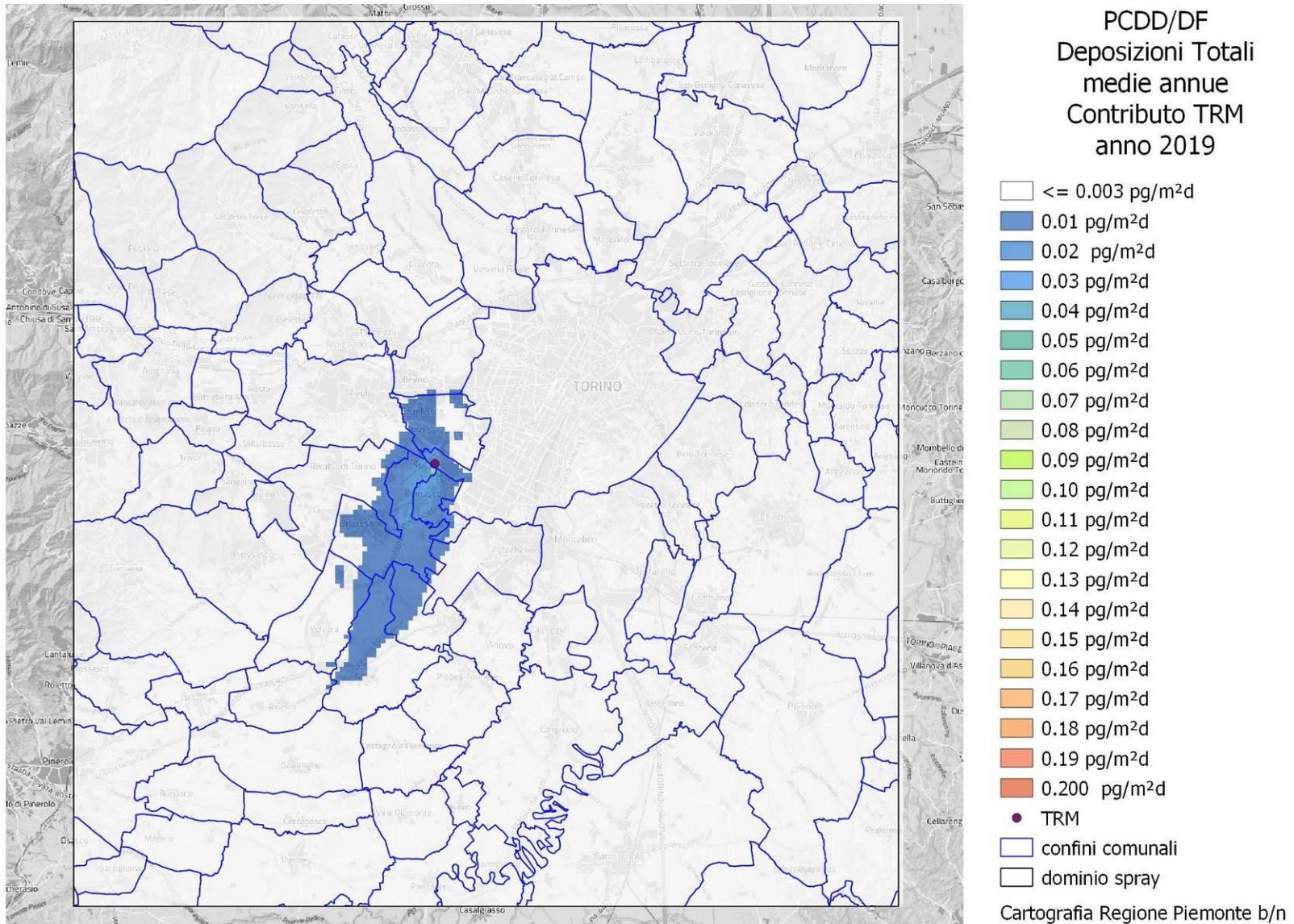
**Figura A45:** Policlorodibenzodiossine/policlorodibenzofurani – Deposizioni totali medie annue – 2019
