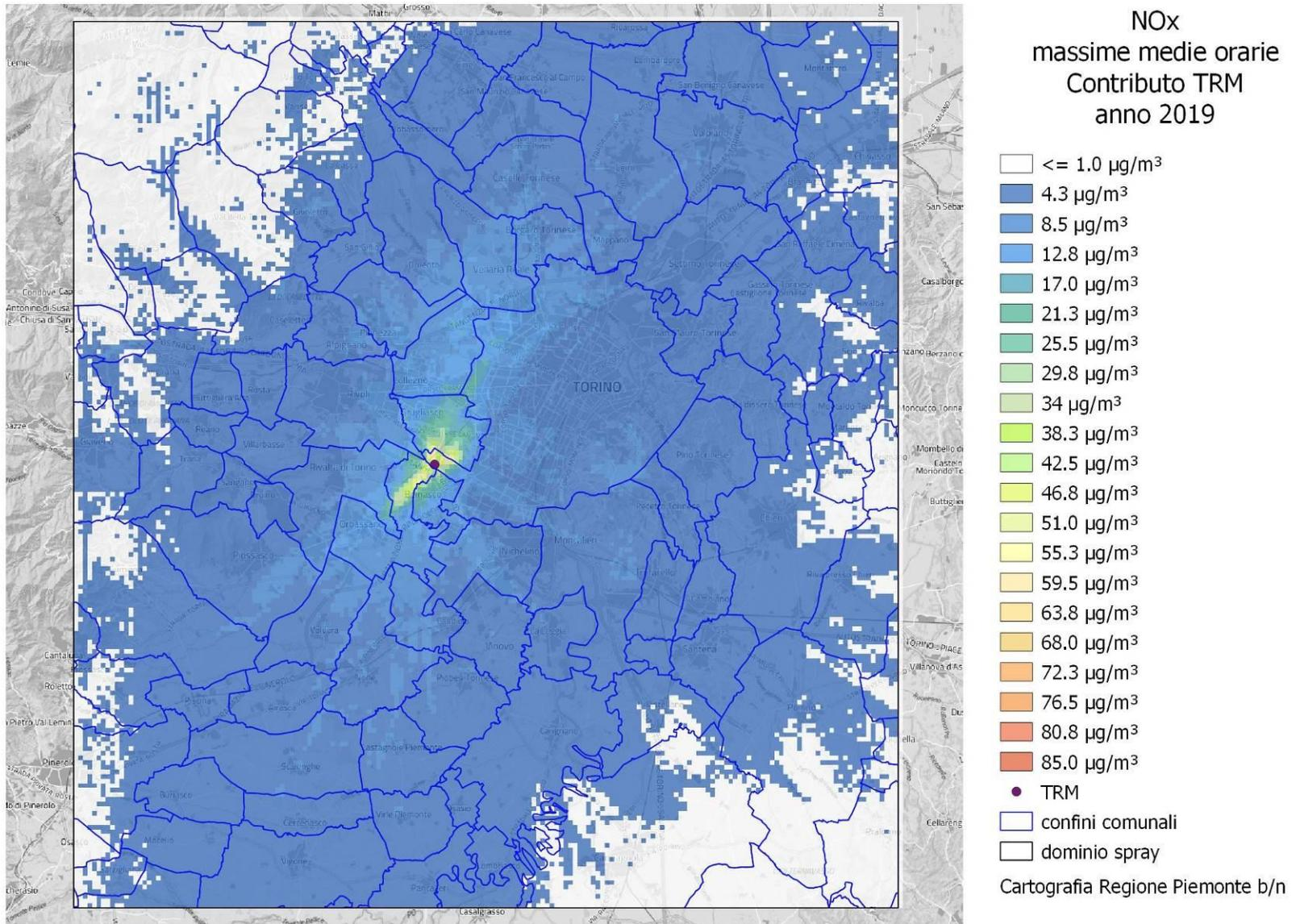
**Figura A8:** Ossidi di azoto (espressi come NO<sub>2</sub>) – concentrazione massima media oraria – 2019
