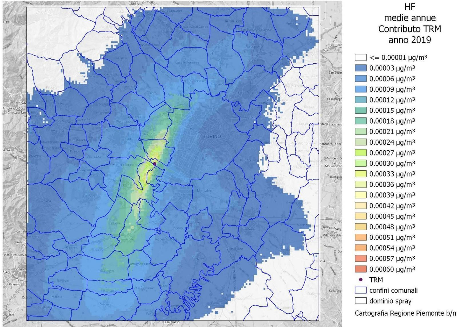
**Figura A22:** Acido fluoridrico – concentrazione media annua – 2019
