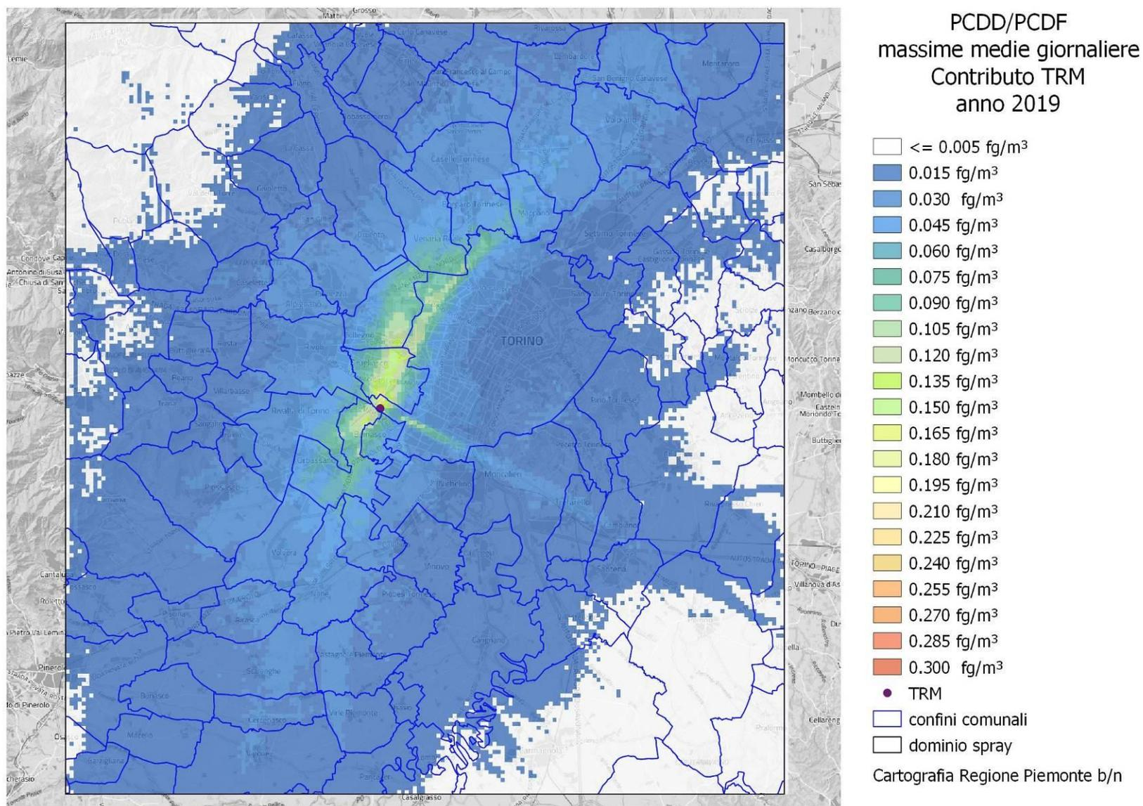
**Figura A44:** Policlorodibenzodiossine/policlorodibenzofurani – concentrazione massima media giornaliera – 2019
