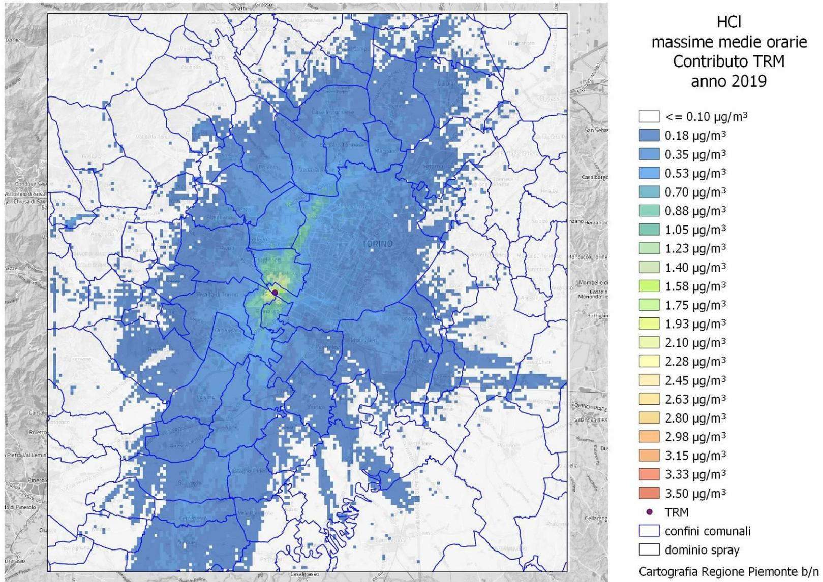
**Figura A21:** Acido cloridrico – concentrazione massima media oraria – 2019
