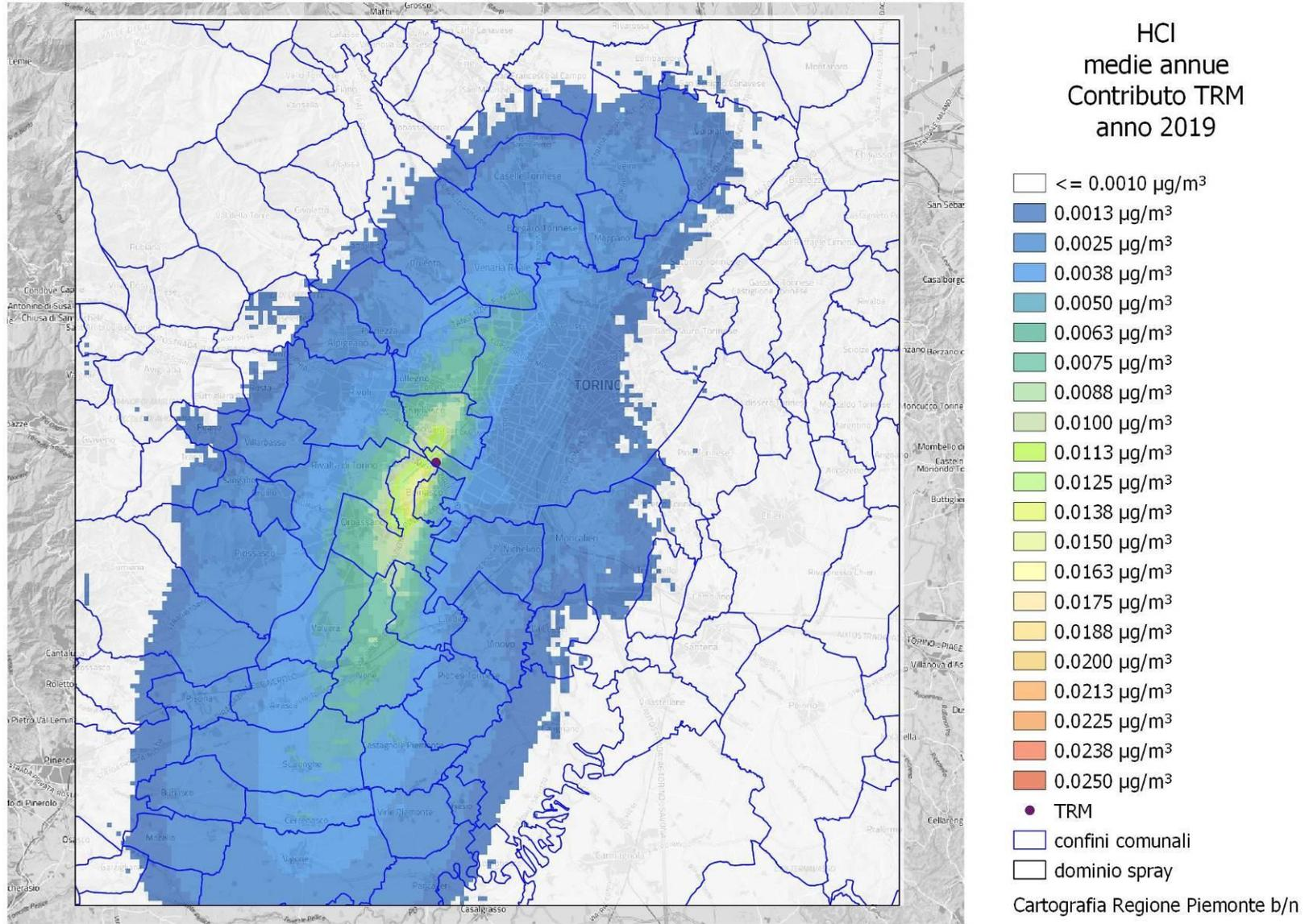
**Figura A20: Acido cloridrico – concentrazione media annua – 2019**
