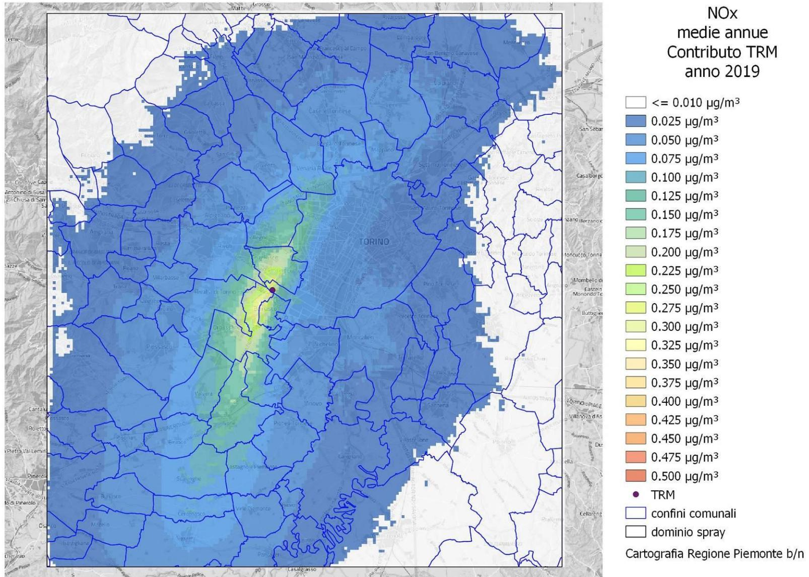
**Figura A6:** Ossidi di azoto (espressi come NO<sub>2</sub>) – concentrazione media annua – 2019
