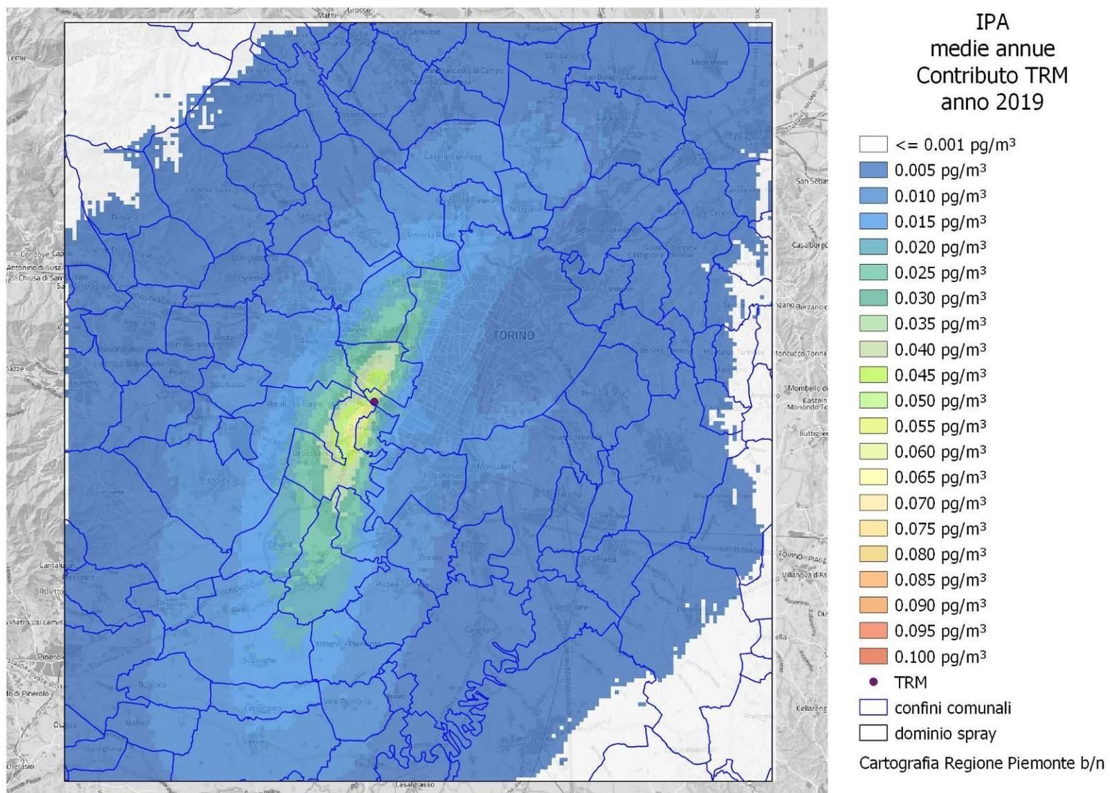
**Figura A40:** Idrocarburi policiclici aromatici – concentrazione media annua – 2019
