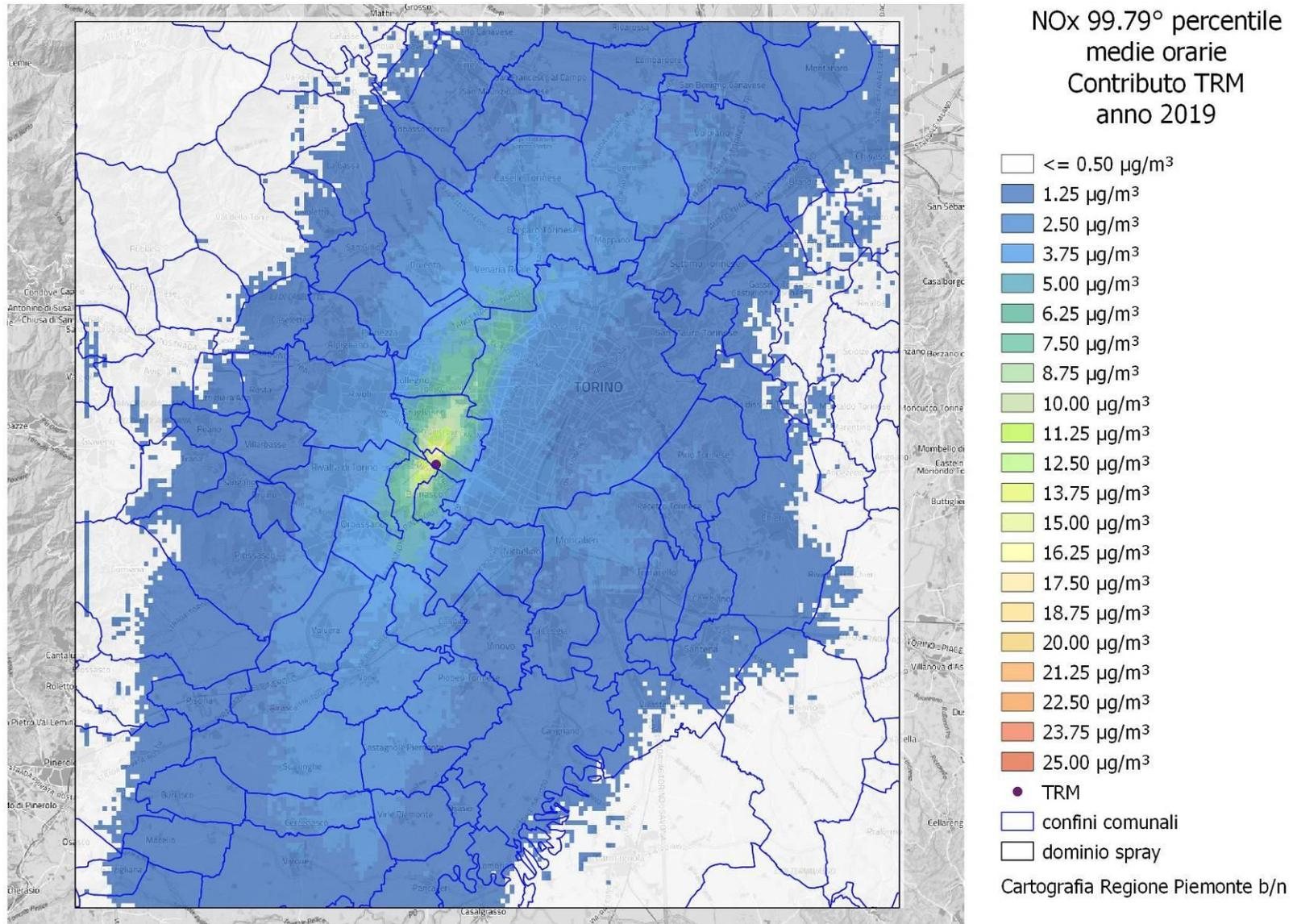
**Figura A7:** Ossidi di azoto (espressi come NO<sub>2</sub>) – 99.79° percentile concentrazioni orarie – 2019
